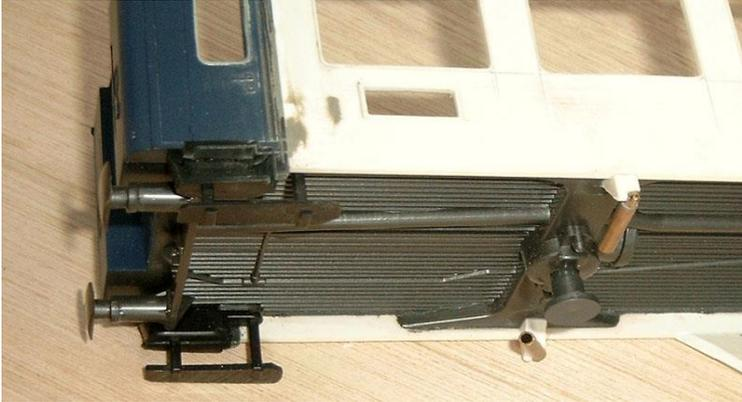
Gleichfalls wird das Drehgestell zugestüst mit ein scharnierendes Stabchen, das in das Rohr genau passt.
