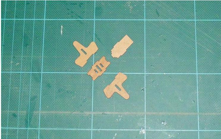
Das senkrechte Rückenwandteil wird mit die Lippe in das Seitenteil geklebt.
