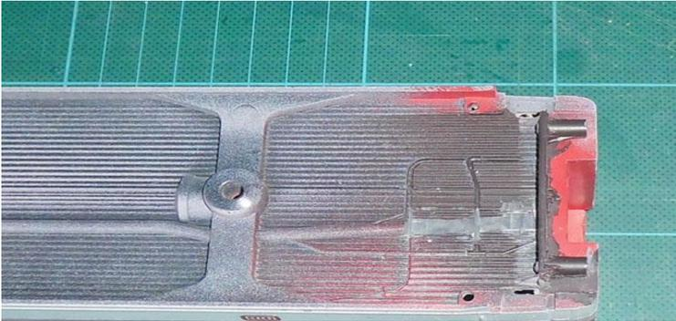
Die Innenausstattung wird auf die Bodenplatte ins Gehäuse geschraubt.
