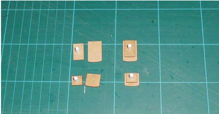
Abteil Wände und die Bodenplatte sind ausgelasert in 1.5 mm MDF.
